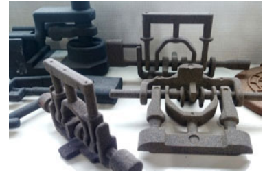
シェルモールド精密鋳造法での高品質な中子
